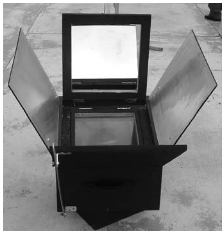
Figura 7. Cocina solar tipo caja con cuatro reflectores (R. Acosta-Universidad de Quintana Roo 2004).
