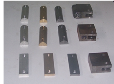
Figura 2. Elementos de contacto: a) puntual, b) lineal y c) superficial.
