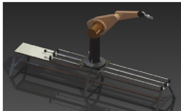
Figura 2. Sistema de traslación de robots sobre un riel usado en celdas de manufactura didácticas.
