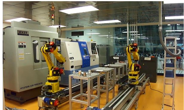
Figura 1. Sistema de traslación para robots en celdas de manufactura.
