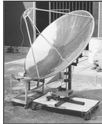
Figura 7. Estructura de soporte del colector.
