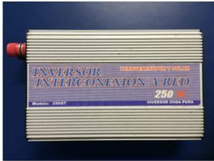
Figura 6 Inversor con interconexión a la red
